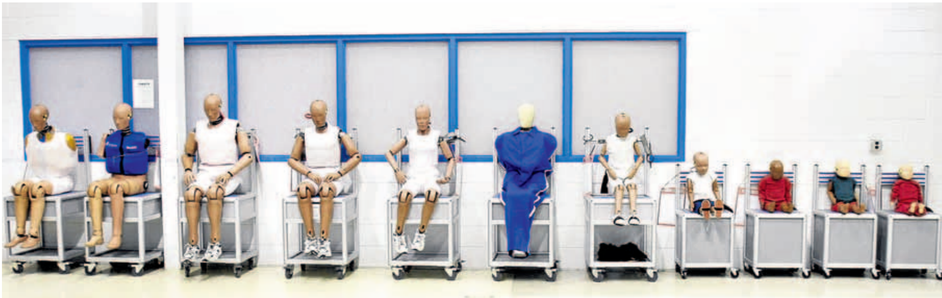
Una batería de 'dummies' (muñecos) empleados para testar los sistemas de seguridad de los vehículos. R. C.
